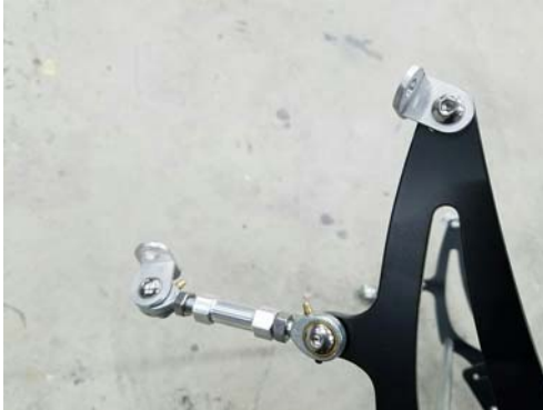
翼の取り付け部（イモネジ付属がステア側）
